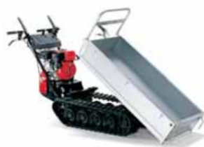
HP 500 Motoros szállítóeszköz 3,6 kW teljesítmény 500 kg terhelhetőség 15 fokos kapaszkodó képesség Hidrosztatikus meghajtás
